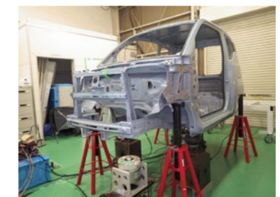
写真1 BEVボディ加振試験
