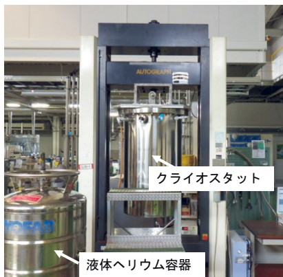
試験装置外観 (万能試験機)
