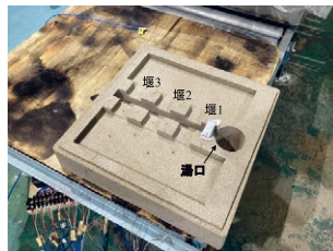
第 2 図 試作用砂型
