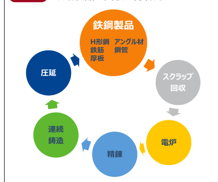
第1図 鉄鋼製品の回収・再利用
