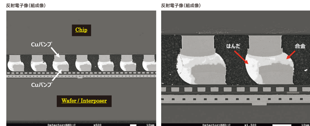
第7図 Chip on Wafer 接合部の拡大観察
