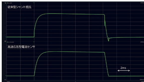
第3図 従来型シャント抵抗と高速応答型電流センサの電流波形
