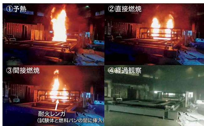
■第1図 UN/ECE R100 耐火試験状況
