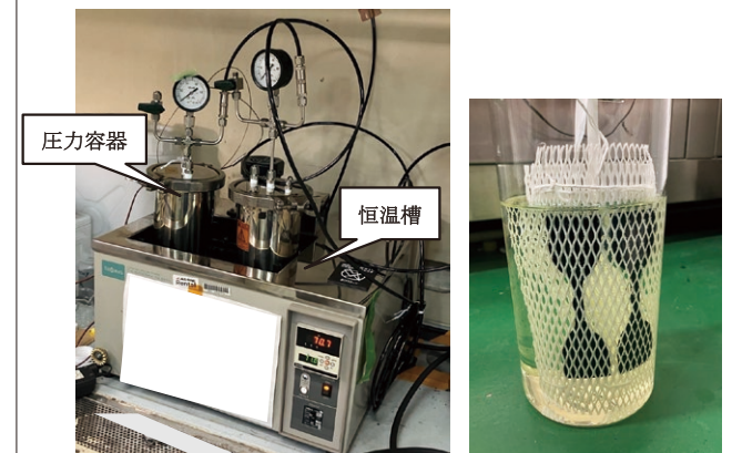
図 4 燃料浸漬装置と浸漬状況
