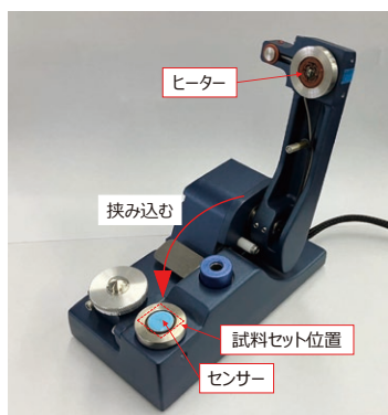
■図2 装置模式図および測定原理
